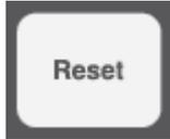
Mit Reset kann die Zähleranzeige auf 0 gesetzt werden.
