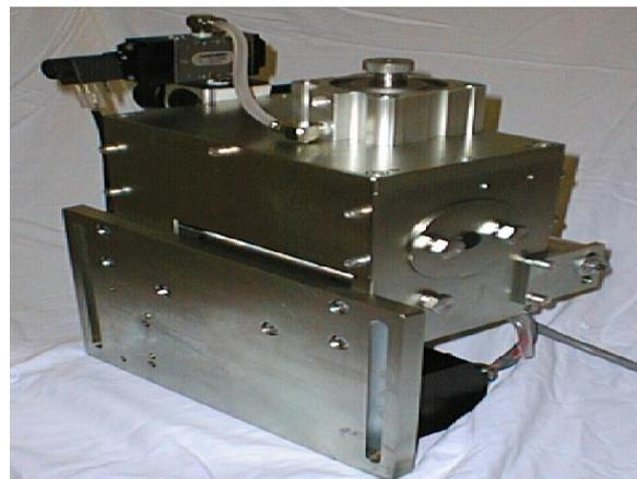
Kippschalter auf „Walze auf“ => Band einführen => „Walze zu“ => Einstellrad zudrehen bis Widerstand spürbar => 1 Umdrehung zurückdrehen => Fertig!
