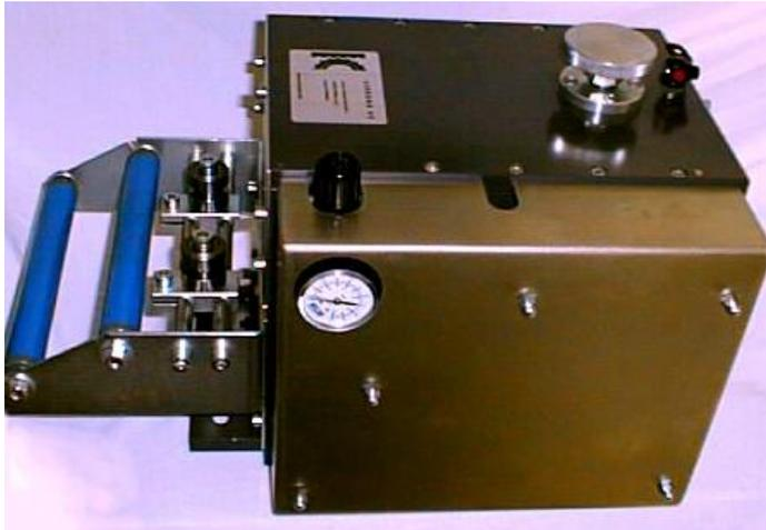
Kippschalter auf „Walze auf“ => Band einführen => Einstellrad zudrehen bis Widerstand spürbar => 1 Umdrehung zurückdrehen => Fertig!
